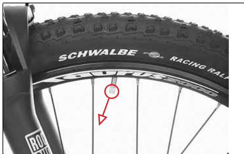
Ventil zeigt nicht zum Laufradmittelpunkt
